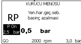
Şekil 17: Yeniden başlatma basıncının ayarlanması
