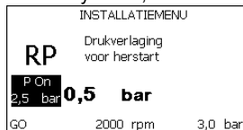
Afb. 17: Instelling van de herstartdruk
