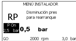
Figura 17: Configuración de la presión de reencendido
